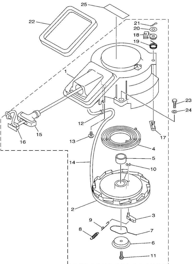
**FIG. 7 STARTER** 起动器总成
