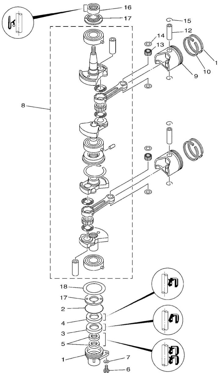
**FIG. 3 CRANKSHAFT & PISTON** 曲轴活塞连杆总成
